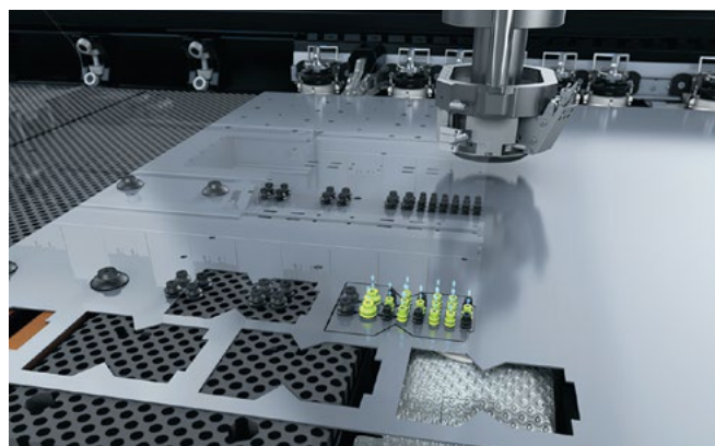
Přísavkové lišty s jednotlivě ovladatelnými přísavkami.
