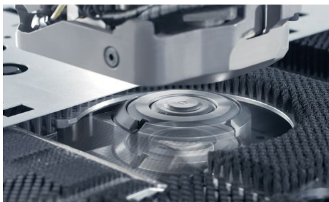
Aktivní matrice zaručuje díly bez poškrábání.
