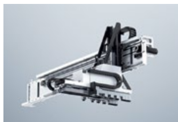
Se systémem SortMaster Compact stohujete hotové díly na standardní odkládací jednotky.
