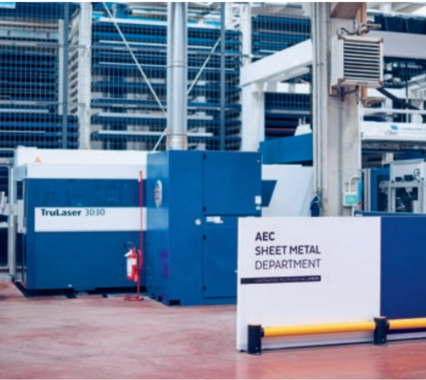
Con la máquina de corte por láser en 2D TruLaser 3030 fiber, AEC Illuminazione sentó las bases de una estrecha colaboración con TRUMPF. La conexión a un almacén automatizado ha acelerado enormemente la producción.
