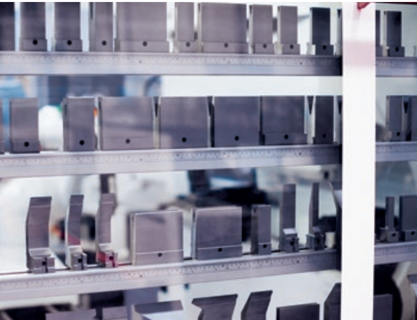
Para absorber los picos de utilización de la capacidad de las máquinas, Giacomo Bianchi ha invertido en útiles que permiten fabricar piezas tanto en la TruBend Cell 7000 como en la TruBend Cell 5000.
