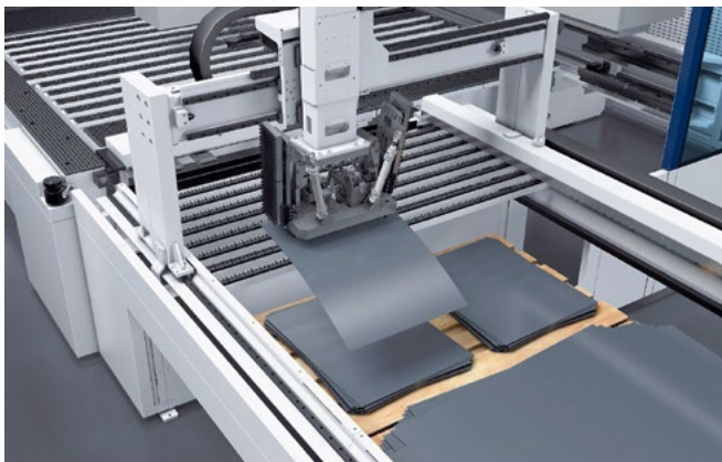
La pinza de ventosa carga automáticamente la TruBend Center 7030 con chapas grandes o pequeñas, mientras la máquina está en funcionamiento.
