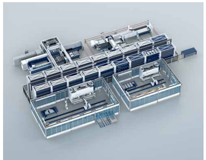
TruBend 5170 con BendMaster (60), carril de desplazamiento de 12 o 14 m, estación de retirada de chapa con mesa giratoria, dos consolas de cambio de pinza, cinta transportadora con dos transportadores de bandejas con conexión a un almacén.
