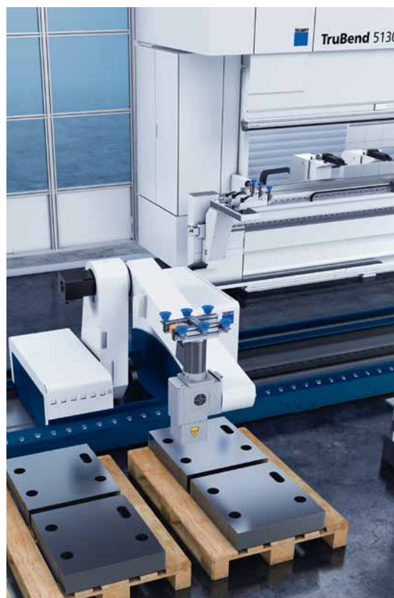
BendMaster (60) con detección de la posición precisa
