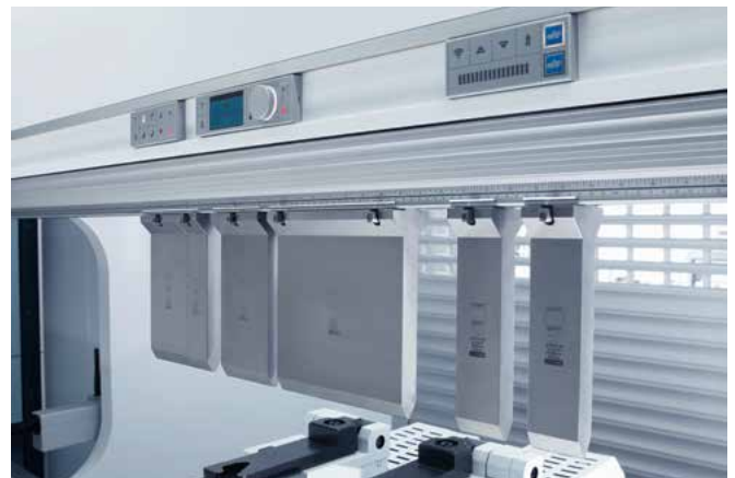
Durante el equipamiento, el Tool Indicator indica exactamente dónde se deben colocar los útiles de plegado.
