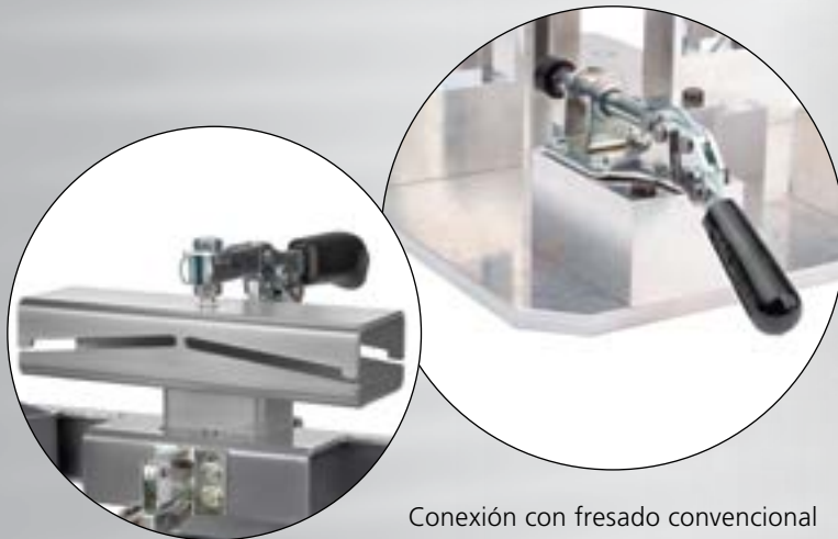
Conexión optimizada hecha con tubos
