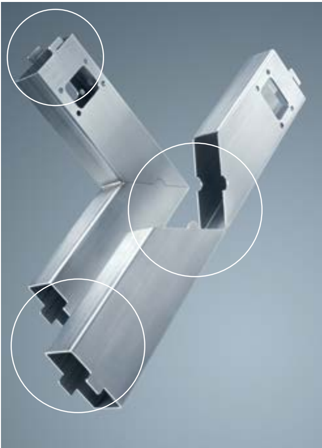
Fabricación eficiente de conexiones en ángulo y ayudas de posicionamiento con el láser.
