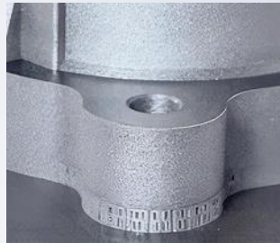
Componente impreso con pre calentamiento a 500 °C.
