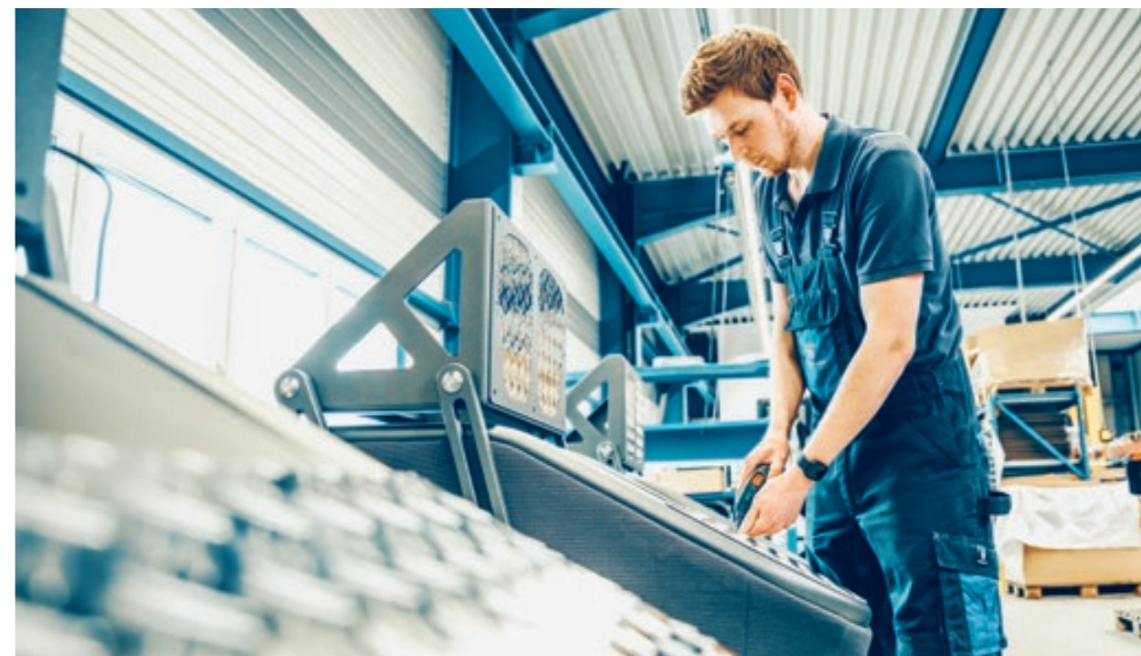
Potente y precisa: la TruMatic 7000 corta y conforma las chapas estriadas de aluminio de las máquinas de EGYM sin arañazos y con la máxima calidad.
