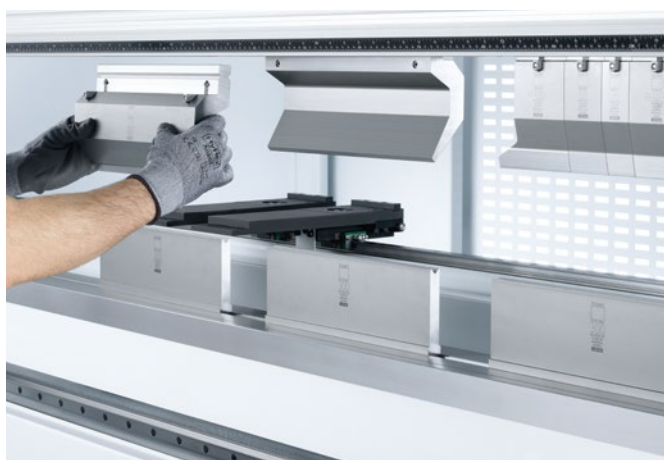
A Safety Click segítségével egyszerűen, alulról elvégezhető a felszerszámozás.
