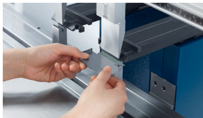
A hajlítási élt jelölő vonallézer pontos pozicionálást tesz lehetővé.
