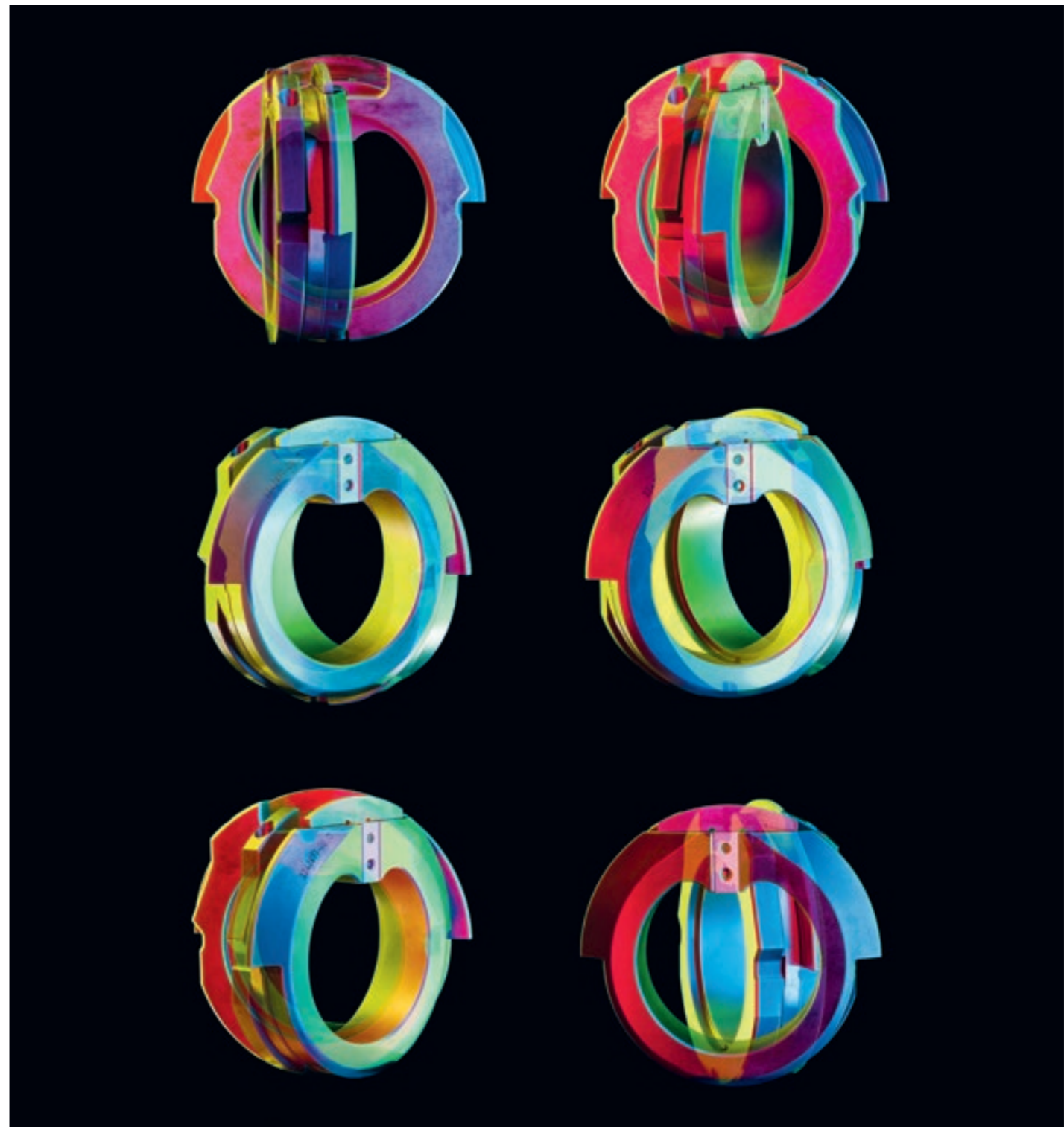
Ebben a kiadásban: A kombinált gépeknél válogatáshoz használt kilököszerszám matricája – ahogyan még soha nem láttuk. A kilököszerszám célzott emeléssel szétválasztja a lézervágott jó munkadarabot és a hulladékot a lemeztől és a megfelelő tárolóba helyezi őket. Jan Kornstaedt fényképész kiemelte a szerszámot a megszokott környezetéből, és teljesen új megvilágításba helyezte.
