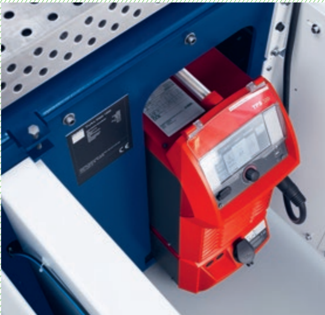
Együttműködés az ívhegesztésben: A TRUMPF a robotcellájában a Fronius hegesztőforrást használja.
