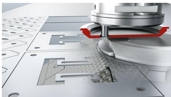
Il vantaggio per voi: i pezzi piccoli vengono separati automaticamente in pezzi buoni e scarti.
