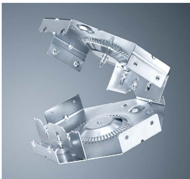
Tecnologie ed utensili utilizzati: punzonatura, sbavatura a rotella, deformazione: filettatura con estrusione verso l'alto e il basso, filettatura lamiera verso l'alto, imbutitura, rifilatura e cerniere, ponti, MultiBend, coniatura.
