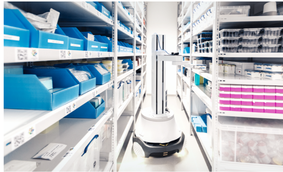
항상 빠르게 움직이는 로봇: 이동 로봇은 한 워크스테이션에서 다른 워크스테이션으로 소모품을 운반하는 등의 실험실 작업을 지원합니다.
