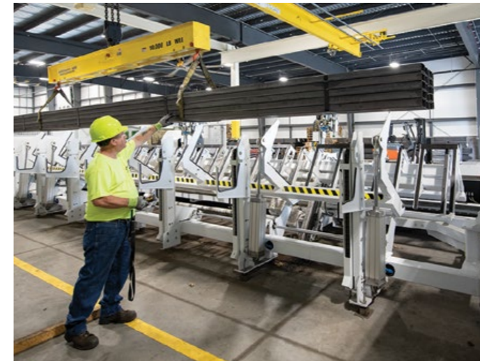
Un empleado de Nitro Cutting carga materia prima en la TruLaser Tube 7000 fiber.
