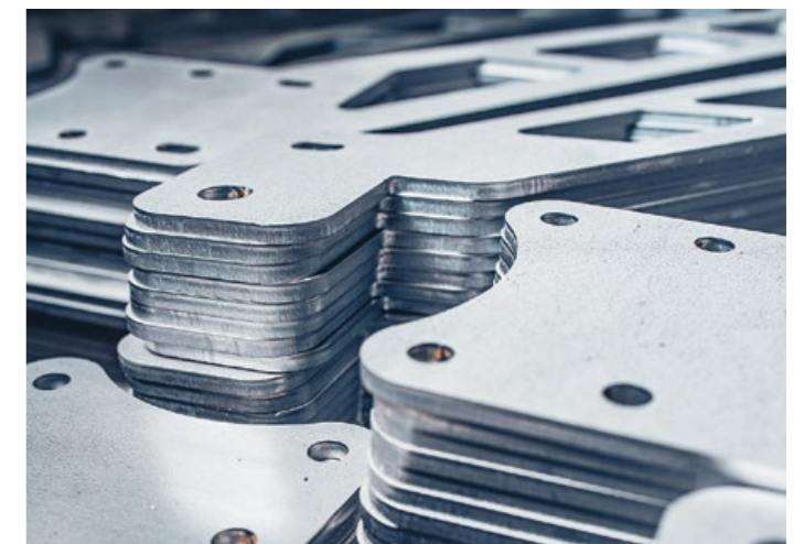
Se exhiben arriba: Acumulación de acero HRPO de 3/16" producido en la TruLaser 5030 fiber de Brunner.
