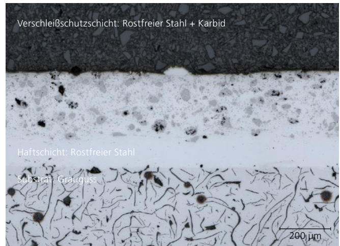
Querschliff einer durch HS-LMD beschichteten Bremsscheibe mit in einer Matrix aus rostfreiem Stahl eingebetteten Karbiden (hier: TiCFeCr).
