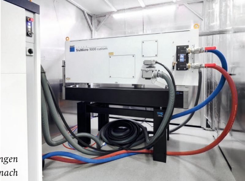
Einer der Versuche: Highspeed-Abtrag einer Polymermatrix bei Compound-Bipolarplatten für die Brennstoffzelle.
