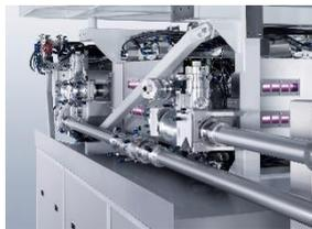
Die Low-Power-CO<sub>2</sub>-Laser von Access Laser dienen mit ihrem Laserlicht als Strahlquelle, die zusammen mit den TRUMPF Laserverstärkern in EUV-Anlagen zum Einsatz kommen.
