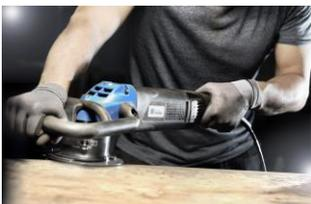
Ergonomisch gestaltete Führungs- und Motorgriffe sorgen dafür, dass der Bediener mit dem neuen Kantenfräser lange ermüdungsfrei arbeiten kann und stets eine hohe Fasenqualität erzielt.
