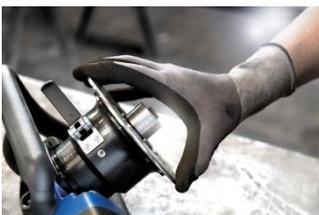
Um die gewünschte Fasenlänge einfach einstellen zu können, hat TRUMPF in den TKA 1500 einen über 270 Grad stufenlos drehbaren Skalenring integriert.
