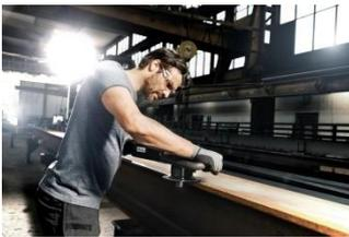
Der neue Kantenfräser TruTool TKA 1500 von TRUMPF erzeugt metallisch blanke Fasen mit bis zu 15 Millimeter Länge.
