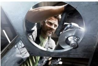
Maschinenbediener können mit dem TruTool TKA 1500 Radien von zwei bis vier Millimeter anbringen.
