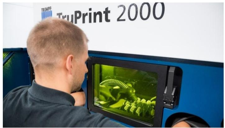
Praktisch: Bauteile einfach entpacken in der TruPrint 2000 unter Schutzgas
