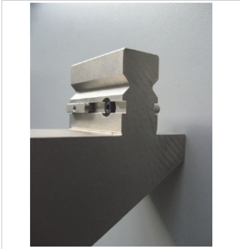
Schultertragendes Oberwerkzeug mit Sicherheitskeil
