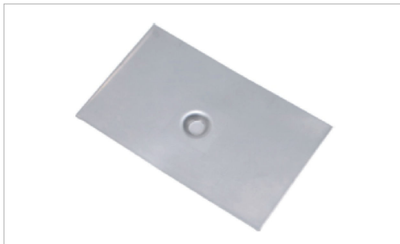
Napfwerkzeug ohne Halteplatte: Werkstück
