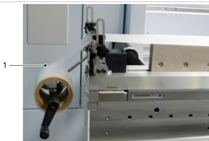
1 Gefahrenstelle BendGuard - Biegefolienhalter (beim Aufbau seitlich zum Maschinentisch)
