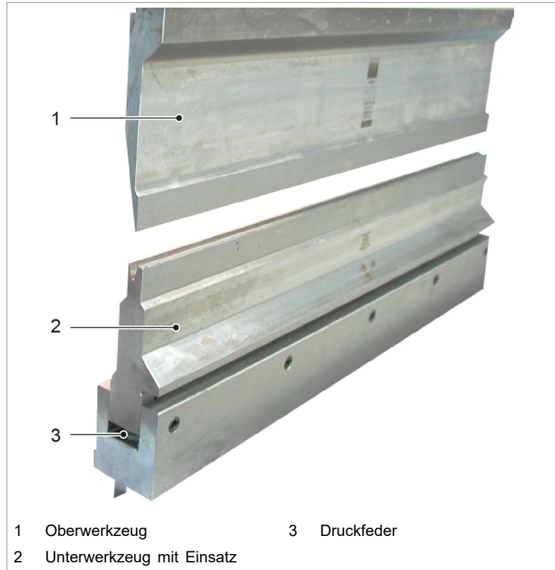
Falzwerkzeug für "geschlossene" Falzungen (Zudrücken) - ohne I-Achsenverschiebung
