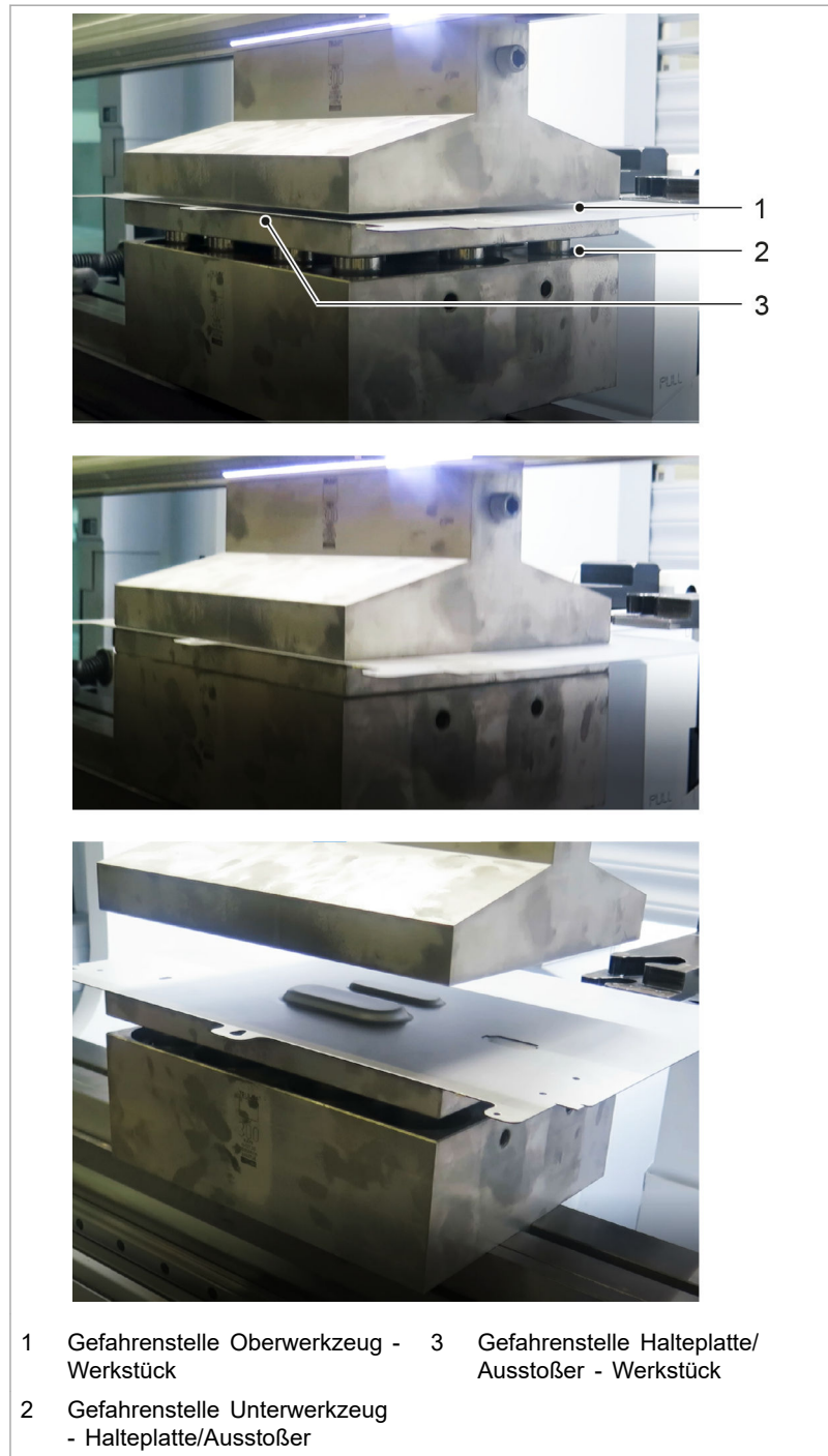
Gefahrenstellen Prägewerkzeug für zwei Spezialformen
