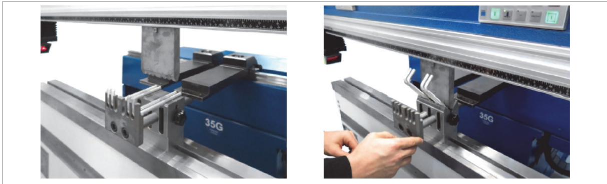
Mehrere Rundstäbe werden in einem Hub abdruckfrei zu Griffen gefertigt - inklusive Anschlag zur Ausrichtung der Bauteile
