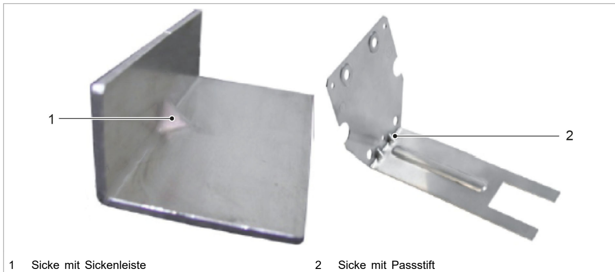
Werkzeuge für Quersicken: Werkstücke
