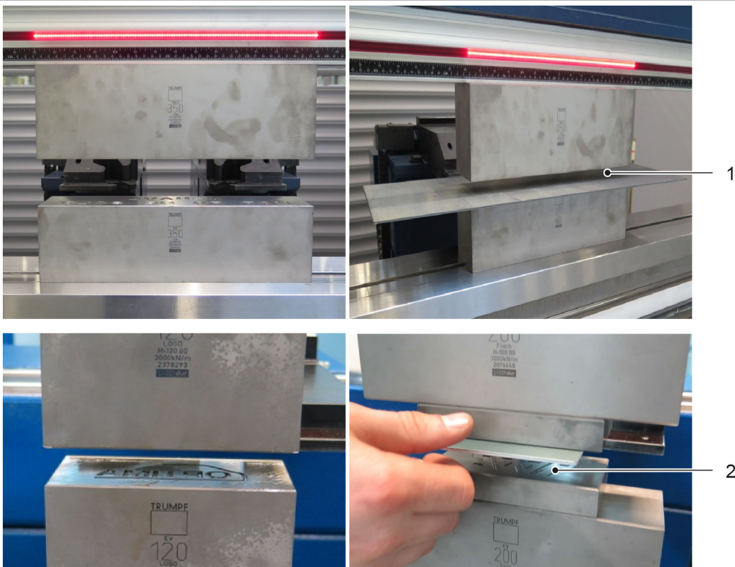
1 Gefahrenstelle Oberwerkzeug - Werkstück
