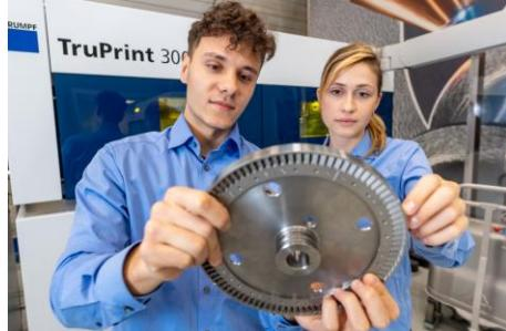
Bildunterschrift: Die Deutsche Bahn lässt Ersatzteile auf den 3D-Druckern von TRUMPF fertigen. Darunter auch ein Turbinenschaufelrad für eine Dampflokomotive, die ohne das Bauteil nicht fahren könnte. (Quelle: TRUMPF)
