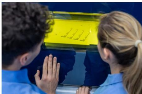
Bildunterschrift: Ein 3D-Drucker von TRUMPF stellt die Form eines Bauteils für einen ICE der Deutschen Bahn her. (Quelle: TRUMPF)
