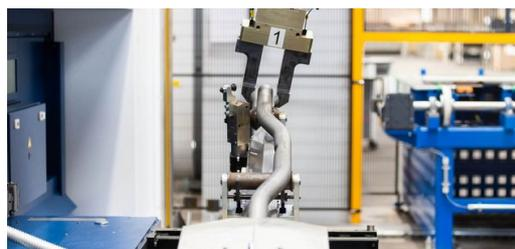
Les installations du réseau de machines sont commandées de manière automatisée par un système robotique qui transporte les pièces d'une étape d'usinage à la suivante.
