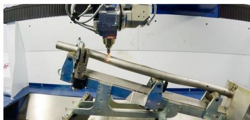
Avec l'installation laser 3D TruLaser Cell 8030 de TRUMPF, il est possible de découper des contours précis qui ne peuvent pas être introduits avant le pliage, car ils se déformeraient.
