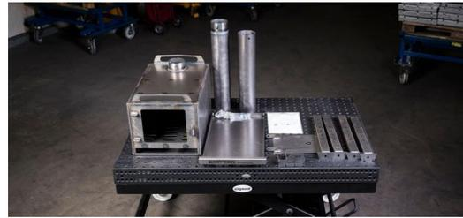
Le four d'extérieur pour l'Ukraine se compose de 22 pièces détachées. Toutes ont été découpées automatiquement par laser, puis pliées et soudées. La poignée du four sert de tournevis et permet de visser ensemble les pièces détachées.
