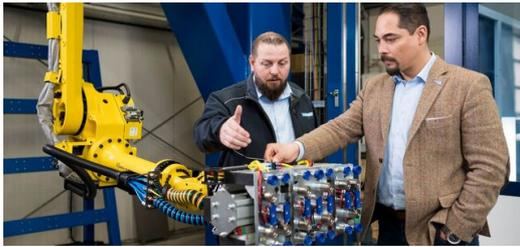
L'automatisation robotique pour le chargement et le déchargement de la TruBend Center 7020 a également été mise en service juste à temps. « Cela accélère encore plus le rythme du processus de production », explique Michael Kuipers (à droite). Karsten Hanenkamp ajoute : « Les préhenseurs posent les pièces usinées sur des palettes préparées à cet effet pour le transport dans l'atelier de soudage. »
