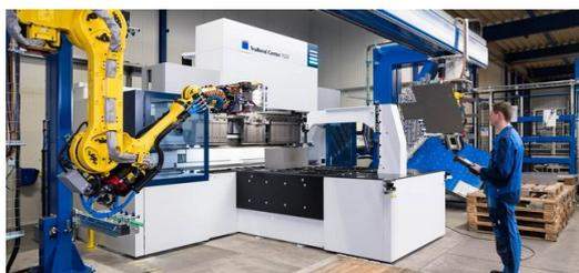
Ce n'est qu'avec le nouveau centre de pliage à plat TruBend Center 7020 que la production des fours d'extérieur a été possible. Grâce à cette installation, l'équipe de Kuipers a pu plier automatiquement le foyer de 333 millimètres, une dimension relativement grande.
