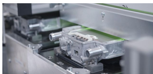
<p>Laser 2 : mise en contact de cuivre au laser vert. La longueur d'onde
