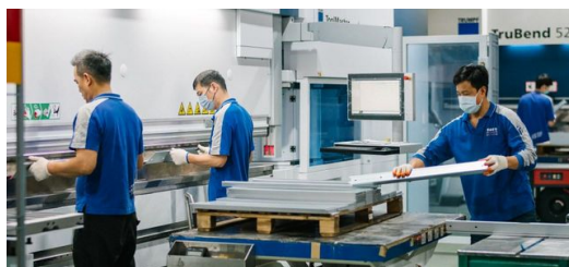
<p>Chaque partie d'un support en C doit être préparée avec précision. Pour le pliage, INTER-TECH utilise une multitude de plieuses TRUMPF.</p>
