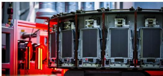
Laser 3 : enlèvement de couche extrêmement précis. Webasto ne pose pas les pistes conductrices en applique mais insère simplement la structure directement dans une fine couche métallique. Les lasers à impulsions ultracourtes de TRUMPF transforment directement le matériau de l'état solide à l'état gazeux et rendent ainsi possible le design plat du produit.
