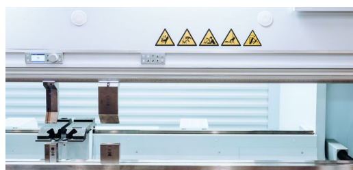
<p><strong>BendGuard :</strong> l'opérateur machine a une vue directe sur les consignes de sécurité, tandis que la technologie BendGuard est invisible – mais elle stoppe la machine en une fraction de seconde, si nécessaire.</p>
