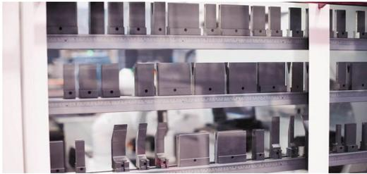
Afin de gérer les pics de production, Giacomo Bianchi a investi dans des outils lui permettant de traiter des pièces aussi bien sur la TruBend Cell 7000 que sur la TruBend Cell 5000.
