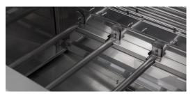
Les quatre tiges de brûleur en acier inoxydable du barbecue au gaz sont coupées sur une machine de découpe laser de tubes TRUMPF et pourvues de 144 trous. Les diamètres de trou de plus en plus petits vers l'arrière garantissent un réchauffement uniforme de l'ensemble de la grille.
