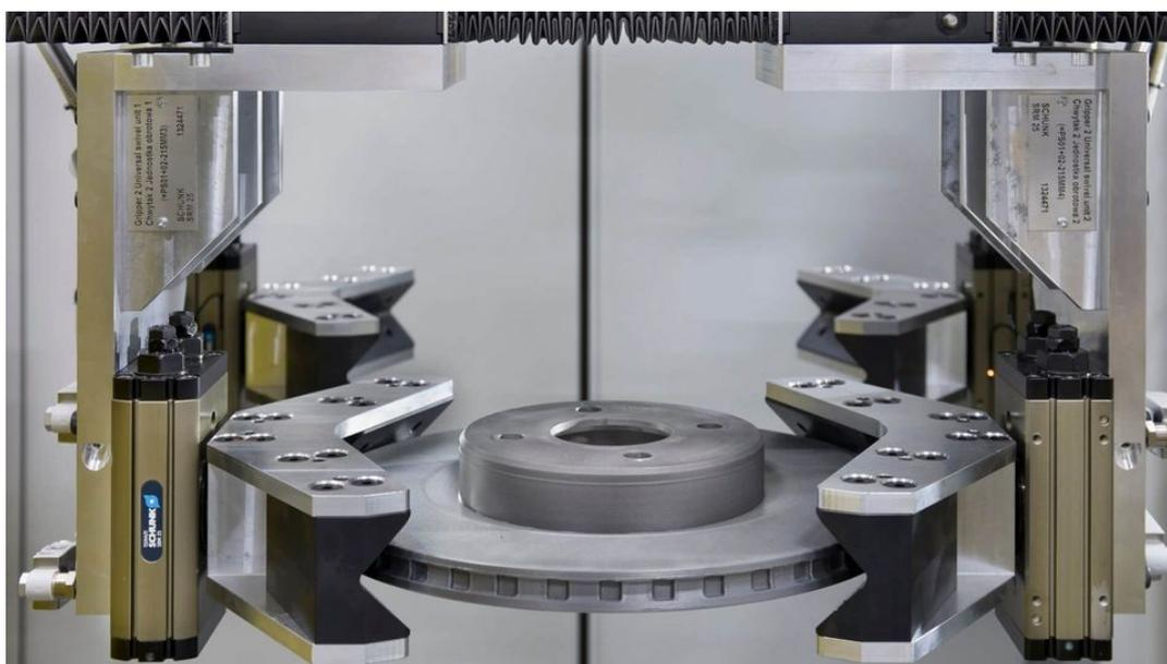
Grâce à la solution BrightLine Weld de TRUMPF, jusqu'à 94 % de la poudre adhère au disque de frein lors du processus de revêtement.
