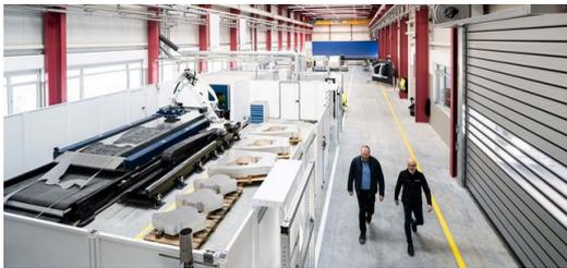
L'installation de Laser Blanking de TRUMPF de 34 mètres de long permet d'économiser de la matière brute et environ 4000 tonnes de CO<sub>2</sub> par an.
