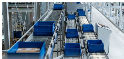
<p>Jusqu'à 120 caisses tournent simultanément à cinq mètres du sol de l'atelier et transportent les pièces détachées vers les différents postes.</p>
