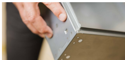
<p>Avec le TruMatic 7000, Max Knobloch peut même effectuer de petites déformations, telles que des marquages par emboutissage ou des raccords par clip.</p>
