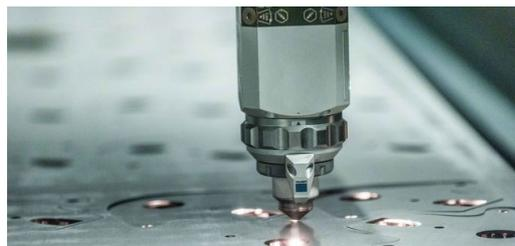
Avec l'option HighSpeed Eco, la consommation d'azote de DELO a baissé de 70 pour cent pour la découpe de feuilles de trois à 20 millimètres d'épaisseur d'acier inoxydable.
