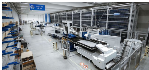
Automatisation : le magasin STOPA organise le flux matières de façon entièrement automatique. Atrea a ainsi considérablement augmenté sa productivité.
