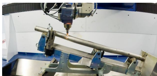
A TRUMPF TruLaser Cell 8030 3D lézerberendezéssel pontos kontúrok vághatóak, amelyeket hajlítás előtt nem lehet alkalmazni, mivel ezek deformálódnának.
