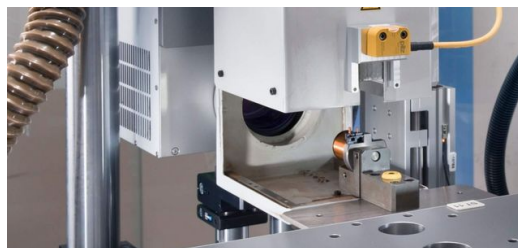
<p>Előtte a TruMark 5010 lézer távolította el a szigetelő festéket a rézhuzalról. Utána kontaktolták a tekercset.</p>
