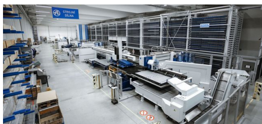
Automatizálás: A STOPA raktár teljesen automatikusan megszervezi az anyagfolyamot. Ezáltal az Atrea jelent:sen növelte termelékenységét.
