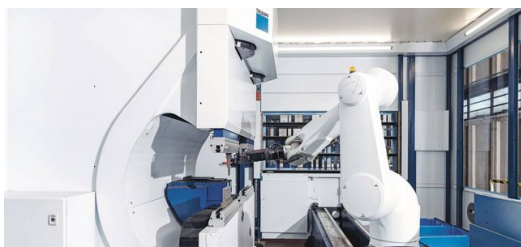
Innovatív nagy sebességű hajlítócella: A TruBend Cell 7000 egy kompakt rendszer a kisméretű munkadarabok rendkívül dinamikus és gazdaságos
