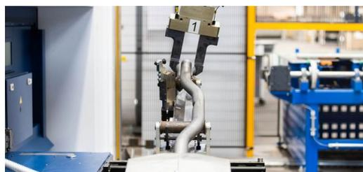
Gli impianti della rete sono gestiti automaticamente da un sistema di robot che trasporta automaticamente i pezzi da una fase di lavorazione all'altra.
