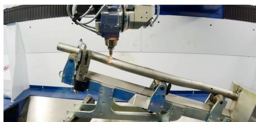
L'impianto laser 3D TruLaser Cell 8030 di TRUMPF taglia contorni precisi che non possono essere applicati prima della piegatura, perché verrebbero altrimenti deformati.
