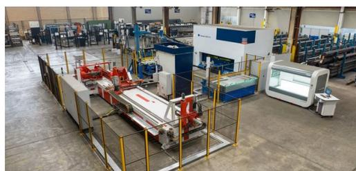
L'interazione di una TruLaser Tube 7000 fiber automatizzata, una TruLaser Cell 8030 di TRUMPF e una piegatrice per tubi di transfluid®, partner di TRUMPF, consente di padroneggiare anche le complesse attività di
