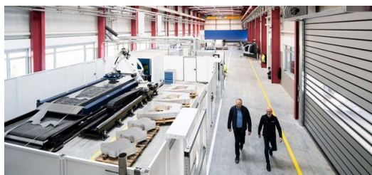
<p>L'impianto di laser blanking di 34 metri di lunghezza di TRUMPF risparmia materiale grezzo e circa 4.000 tonnellate di CO 2 all'anno.</p>
