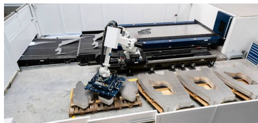
Laser blanking: un robot ordina in automatico i componenti tagliati.
