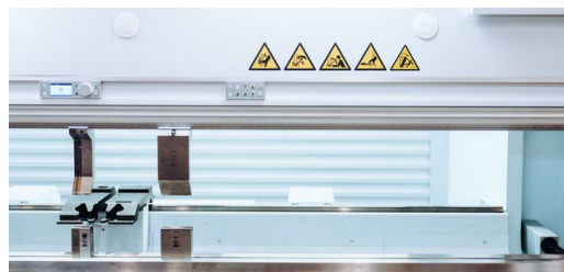
BendGuard: Le istruzioni di sicurezza sono ben visibili all'operatore della macchina, mentre la tecnologia BendGuard è invisibile, ma spegne la macchina in frazioni di secondo in caso di necessità.
