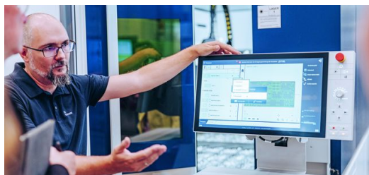
Pannello di comando: Uli Schrade, tecnico della dimostrazione, mostra sul display come tutti i parametri di sicurezza siano visibili a colpo d'occhio, prima che il laser possa avviarsi in sicurezza.
