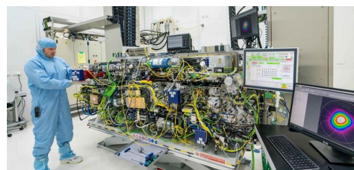
<p>Il cuore della produzione di chip: un componente del laser industriale pulsato più potente al mondo, utilizzato per generare la luce necessaria per la litografia EUV.</p>
