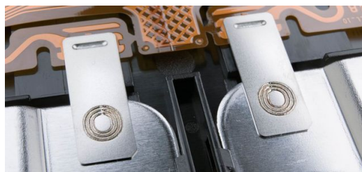
<p>Il sistema di contatto per celle dei pacchetti batteria per veicoli elettrici collega le singole celle della batteria per formare un'unica unità, creando così le condizioni per il trasferimento di energia elettrica dalla batteria all'utenza. Nella produzione in serie di questo importante componente si applica la strategia "zero difetti".</p>
