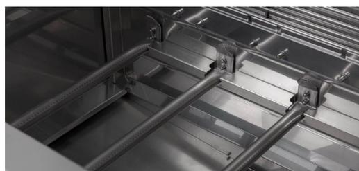
Le quattro aste dei bruciatori in acciaio inox del grill vengono tagliate e forate, con 144 fori l'una, con una macchina taglio laser di tubi TRUMPF. Il diametro del foro diventa sempre più piccolo verso la parte posteriore, garantendo così un riscaldamento uniforme dell'intera griglia.
