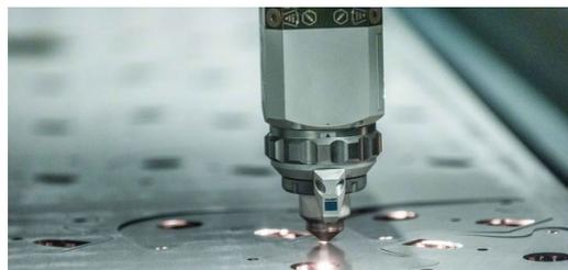
L'opzione HighSpeed Eco consente a DELO di consumare fino al 70 per cento di azoto in meno durante il taglio di acciaio inox con spessore compreso tra tre e 20 millimetri.
