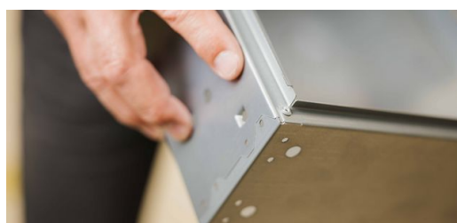
<p>Con la TruMatic 7000, Max Knobloch può eseguire anche piccole operazioni di formatura, come la goffratura a coppa o i collegamenti a clip.</p>
