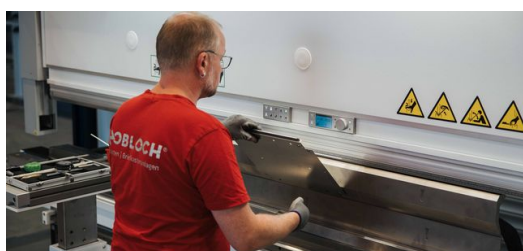
<p>Sulla piegatrice manuale TruBend 5130, un collaboratore lavora pezzi in lamiera per sistemi di cassette postali e realizzazioni su misura.</p>
