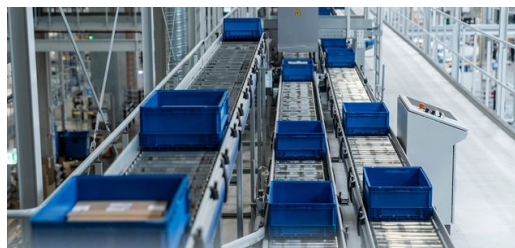
<p>Fino a 120 cassette girano contemporaneamente a cinque metri di altezza dal pavimento del capannone, trasportando i pezzi di ricambio alle varie stazioni.</p>
