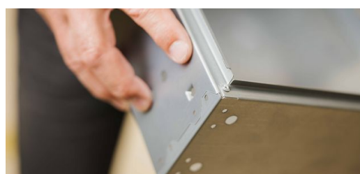
<p>Met de TruMatic 7000 kan Max Knobloch zelfs kleine vervormingen uitvoeren, zoals komvormige stansingen of clipverbindingen.</p>
