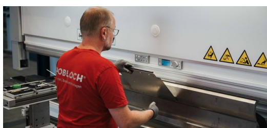
<p>Op de handmatige buigmachine TruBend 5130 bewerkt een medewerker plaatdelen voor brievenbussystemen en maatwerk.</p>
