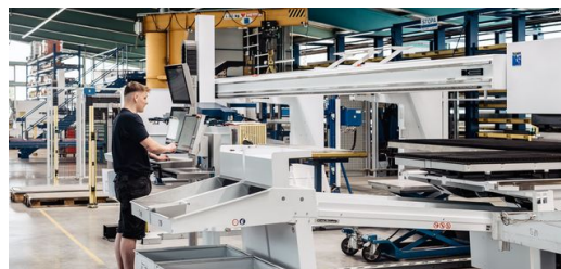
<p>Ultramoderne TruMatic-pons-/lasermachines verkorten de doorlooptijden en verhogen de productiviteit. Hierdoor kan Schimscha ook vaak wisselende opdrachten en individuele wensen van de klant op een rendabele manier uitvoeren.</p>
